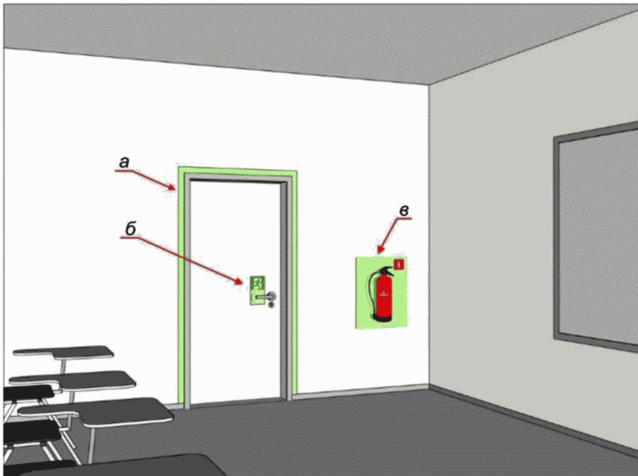
*а* - обозначение контура двери фотолюминесцентной полосой;
