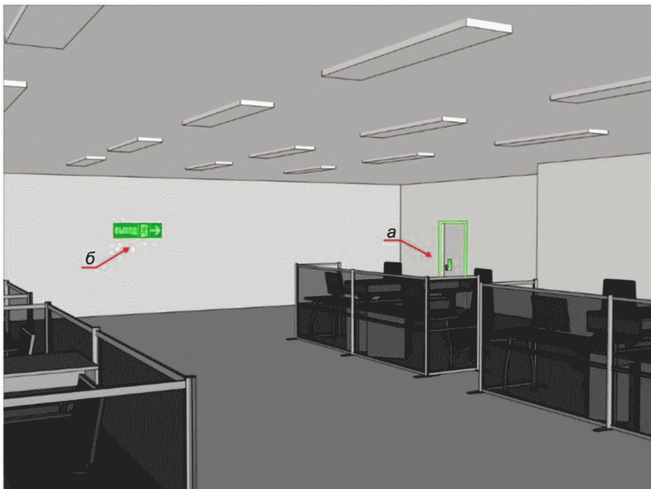
*а* - обозначение контура и механизма двери;
