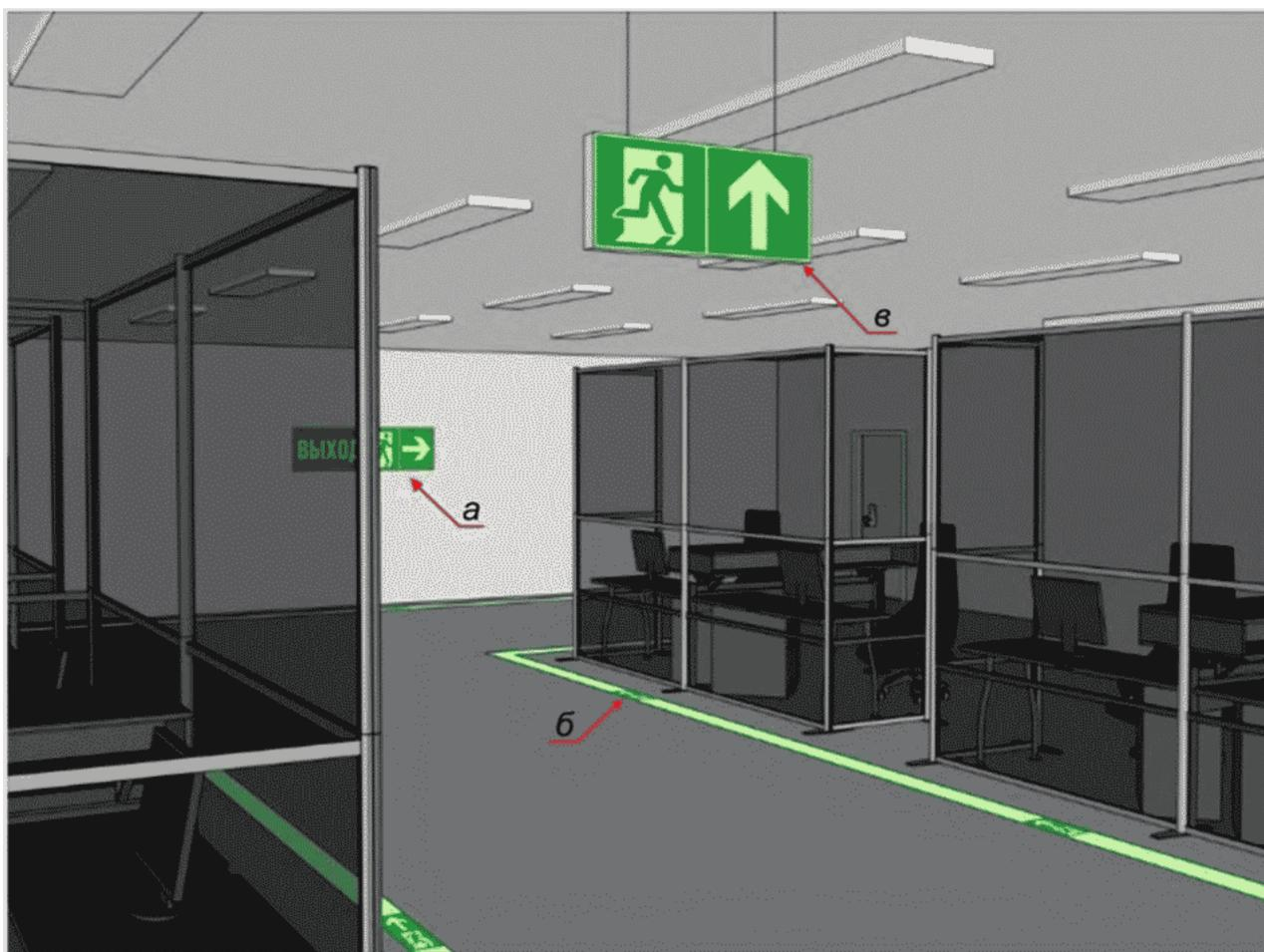
*a* - настенный комбинированный указатель направления эвакуации; *б* - напольная направляющая линия с включенным в ее состав указателем направления эвакуации; *в* - подвесной комбинированный указатель направления эвакуации
