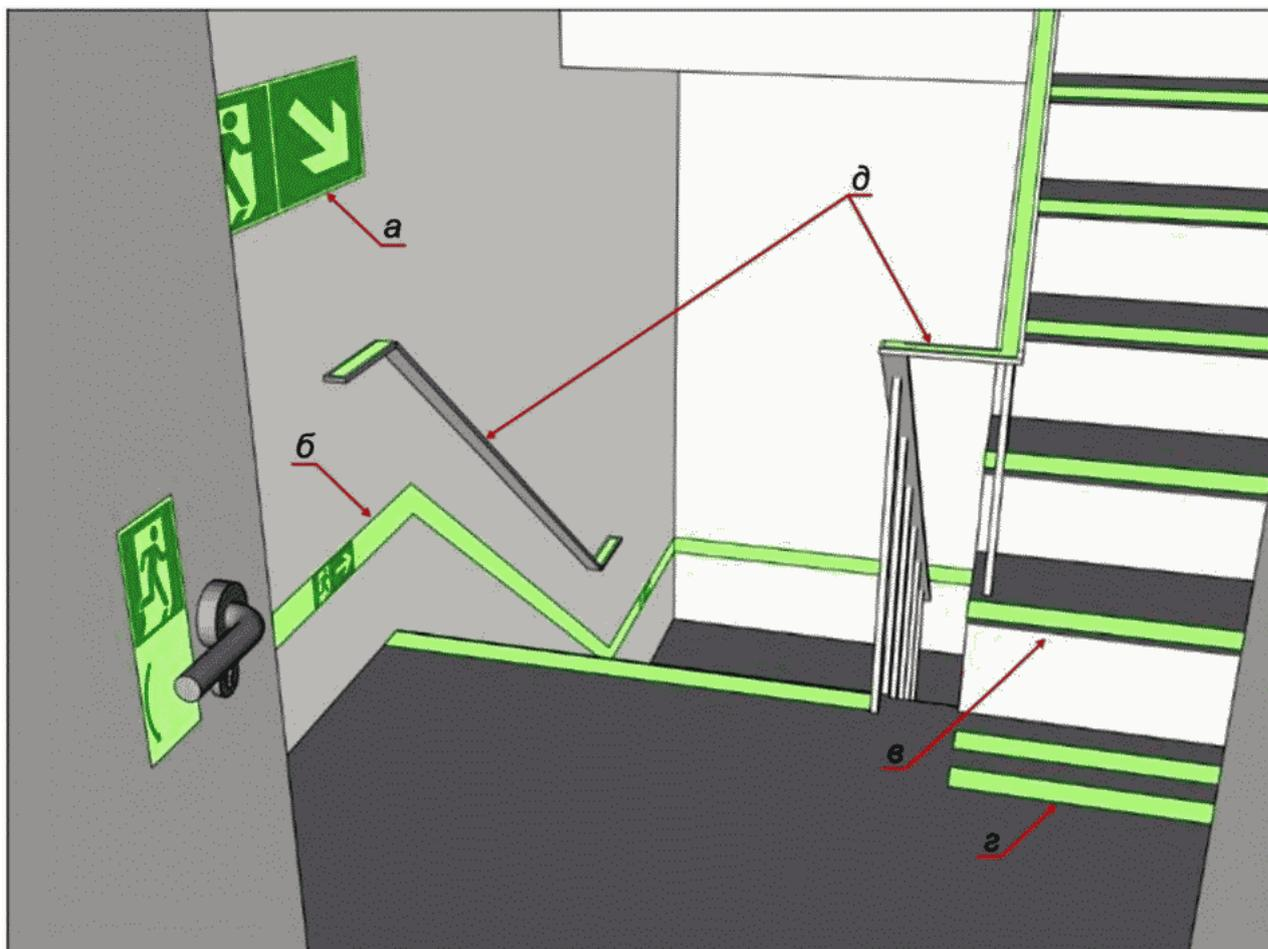
*a* - комбинированный указатель направления эвакуации;
