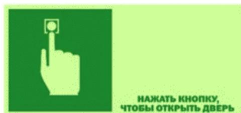
Рисунок 3 - Пример знака для обозначения кнопки экстренного отпирания двери с электронным замком
