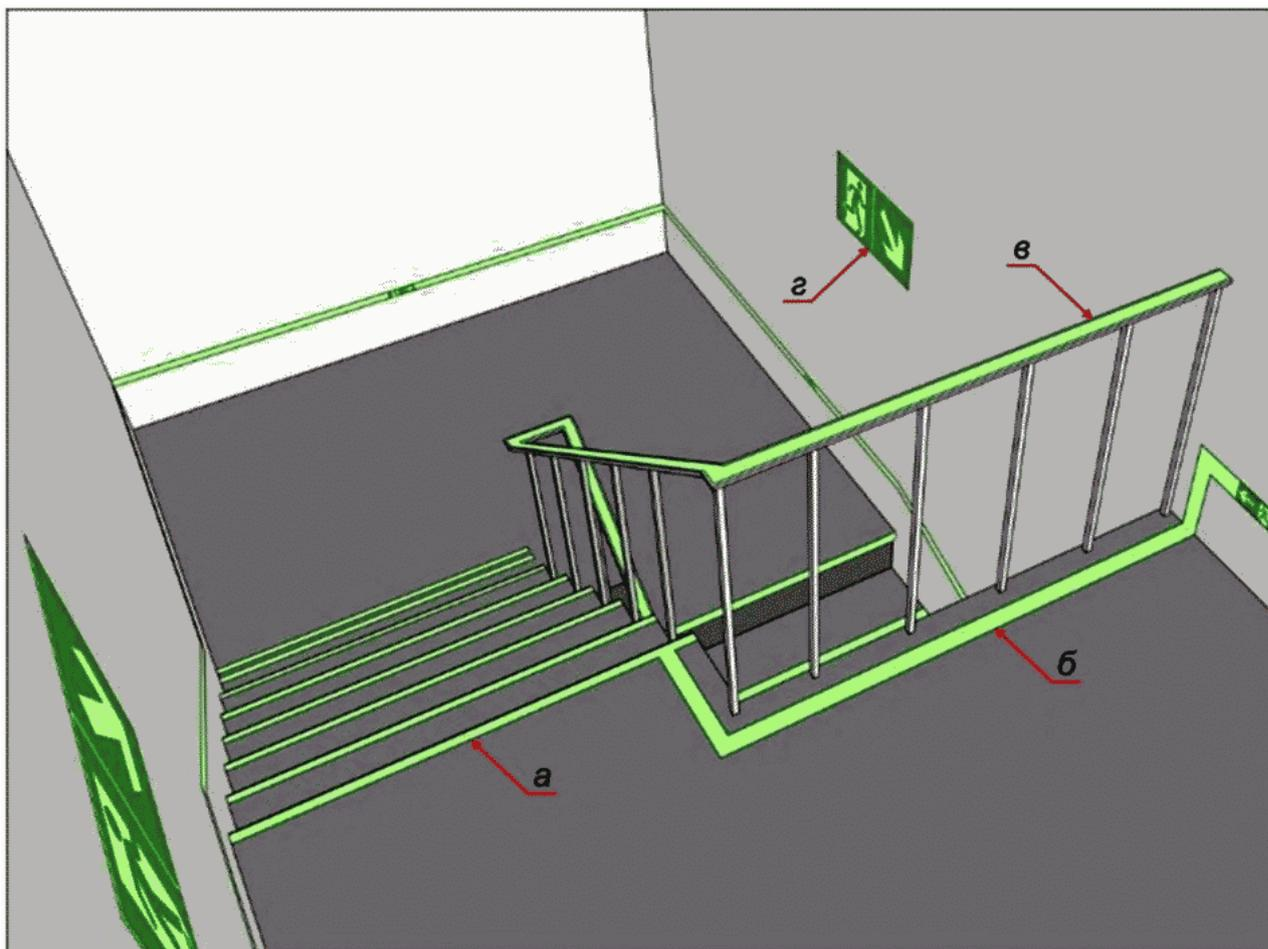
*а* - обозначение переднего горизонтального края ступеней фотолюминесцентными полосами; *б* - обозначение геометрии и края лестничной площадки фотолюминесцентной напольной направляющей линией; *в* - обозначение перил лестницы фотолюминесцентной полосой; *г* - комбинированный указатель направления эвакуации
