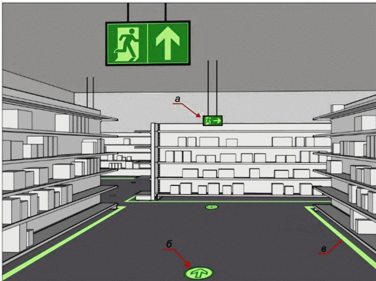
*а* - потолочный комбинированный указатель направления эвакуации; *б* - напольный основной указатель направления эвакуации; *в* - напольная направляющая линия
