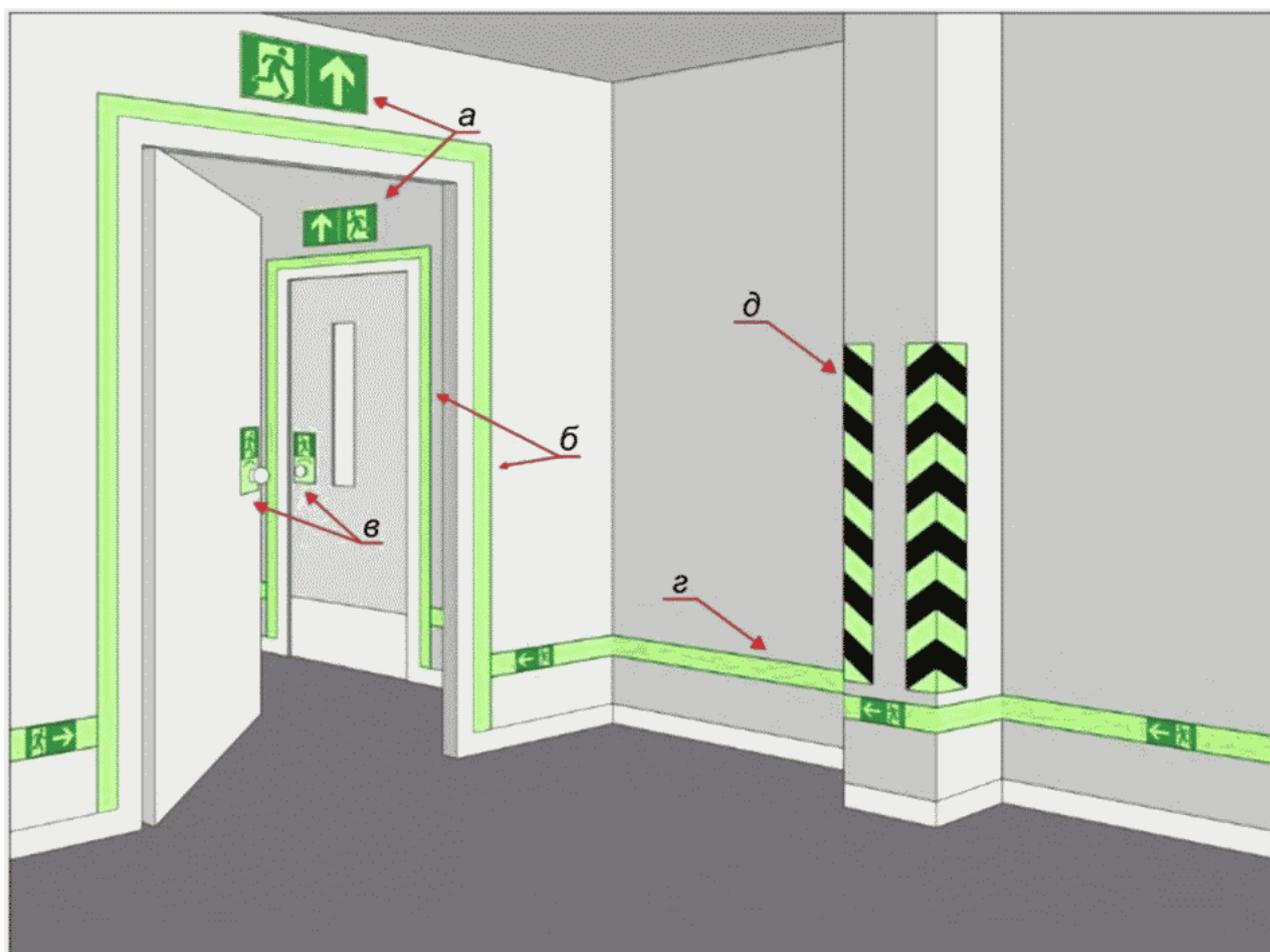
*а* - указатель направления эвакуации, размещенный над выходом; *б* - обозначение контура двери фотолюминесцентной полосой шириной 50 мм; *в* - обозначение механизма двери; *г* - низко расположенная настенная направляющая линия с включенным в ее состав указателем направления эвакуации; *д* - обозначение опасной зоны или конструкции здания, которая может стать причиной травмы
