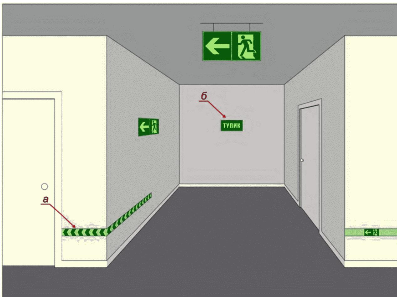
*а* - низко расположенная направляющая линия со стрелками для дополнительного указания направления эвакуации;
