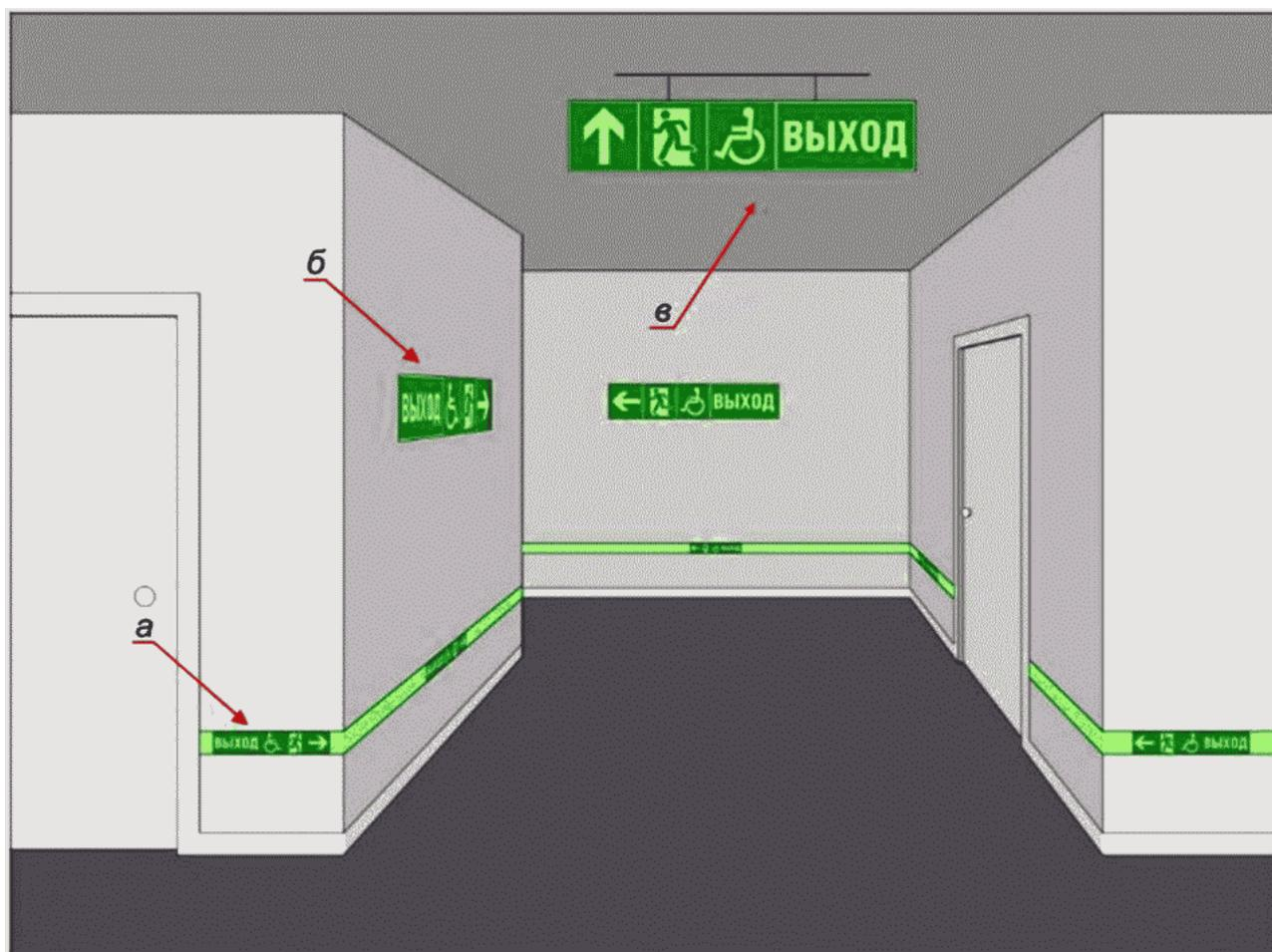
*а* - низко расположенная настенная направляющая линия с включенным в ее состав указателем направления эвакуации;
