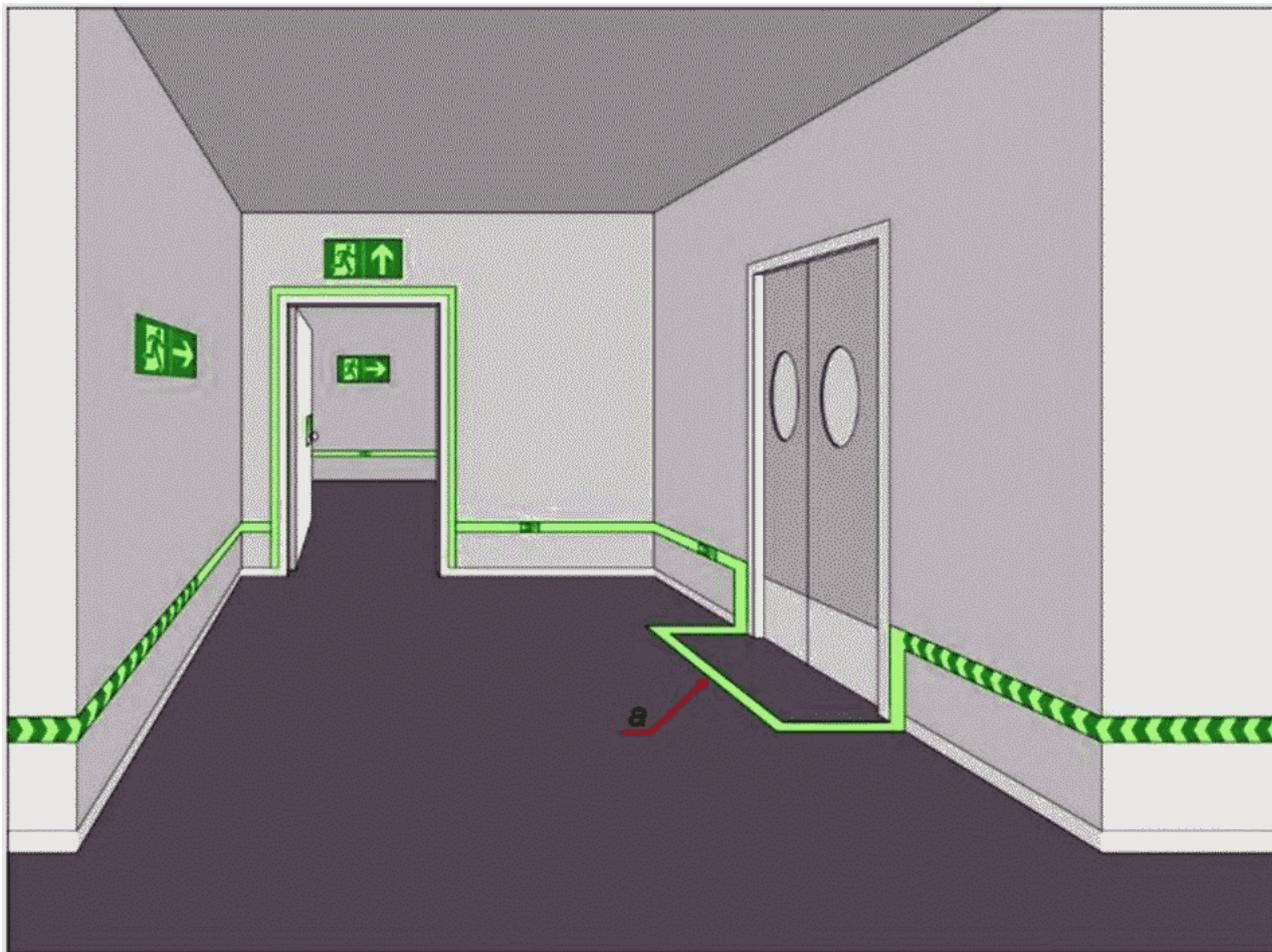
*a* - обозначение геометрии безопасного эвакуационного пути
