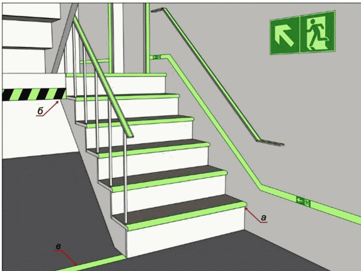
*а* - обозначение переднего горизонтального и вертикального края ступеней фотолюминесцентными полосами; *б* - обозначение опасной зоны или конструкции здания, которая может стать причиной травмы; *в* - обозначение геометрии безопасного эвакуационного пути напольной фотолюминесцентной полосой
