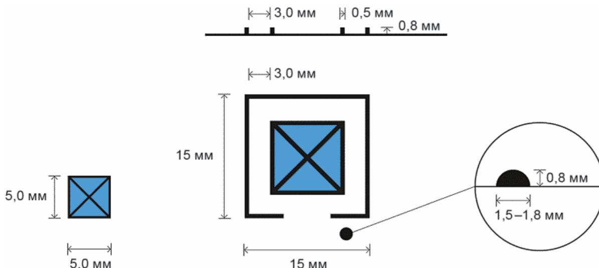
Рисунок 41 - Обозначение лифта на тактильно-визуальной схеме
