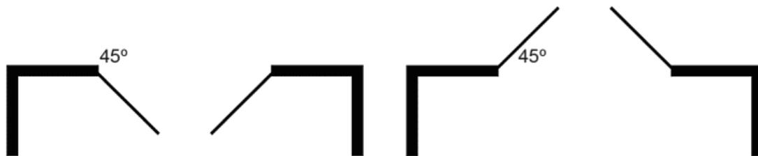
Рисунок 33 - Дверной проем с двустворчатыми дверными полотнами
