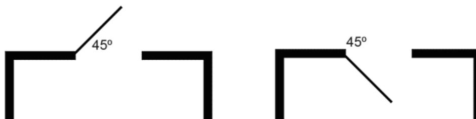
Рисунок 32 - Наружное и внутреннее открывание
