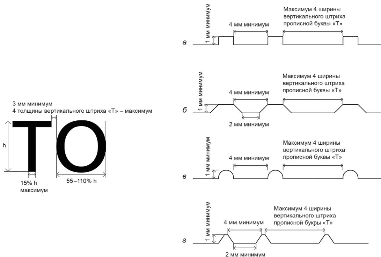
а - прямоугольный рельеф; б - трапециевидный рельеф;
