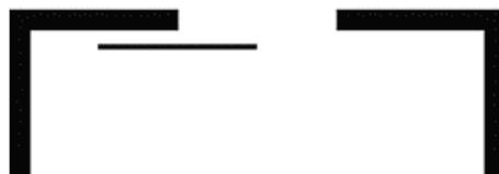
Рисунок 36 - Раздвижное дверное полотно в виде параллельной линии к стене, закрывающее половину дверного проема
