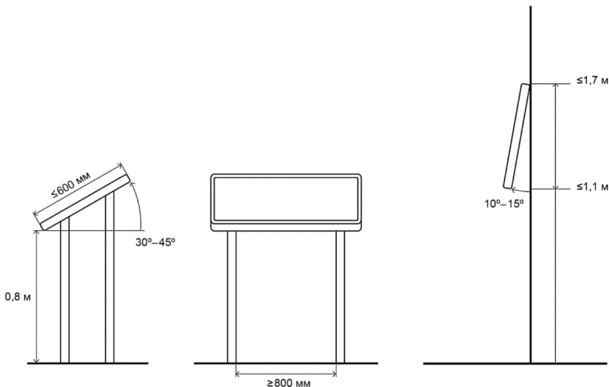
Рисунок 11 - Высота установки тактильно-визуальных схем
