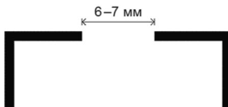
Рисунок 30 - Обозначение дверей, открытого дверного проема
