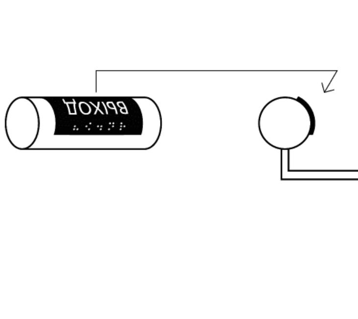
Рисунок 8 - Размещение тактильной информации на поручнях
